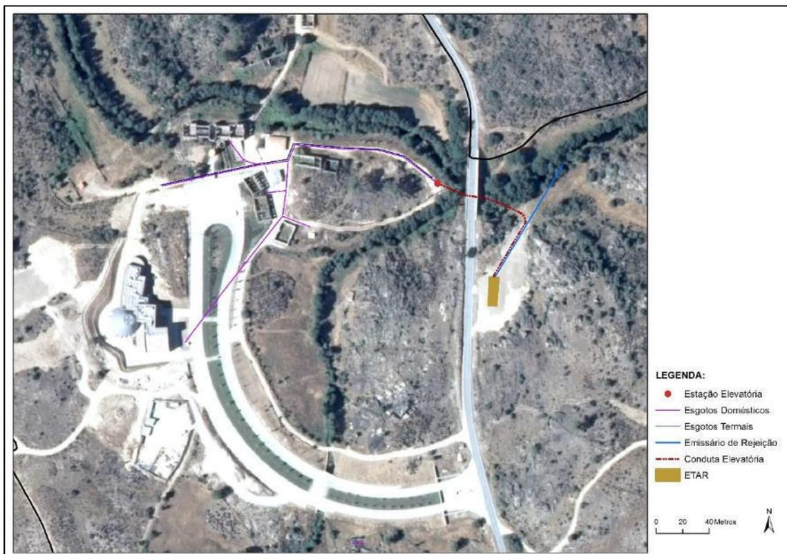
Figura 56: Pormenor da organização e cobertura espacial do sistema de drenagem de águas residuais
