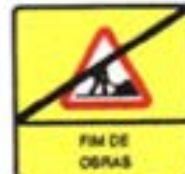
DT13 - Exemplo de sinal de fim de obras
